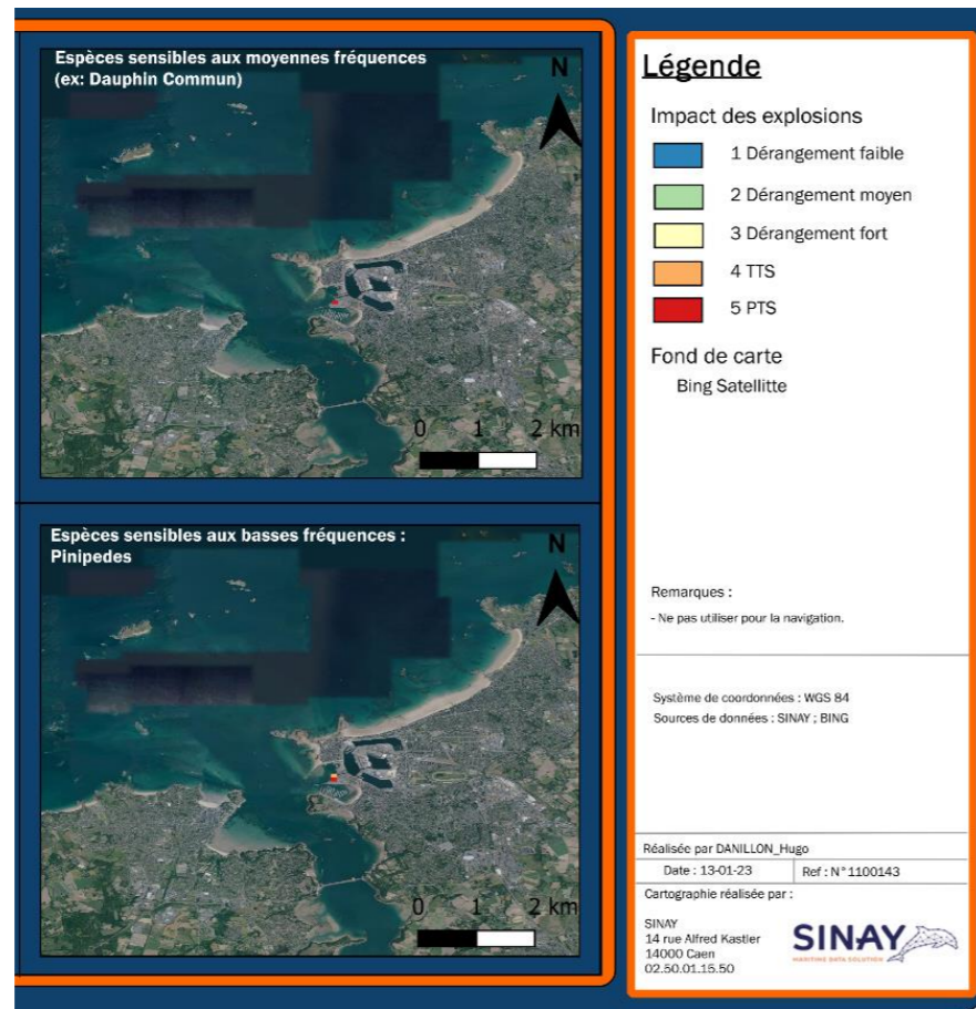
Figure 29 : Impact en bruit impulsif du battage des pieux
