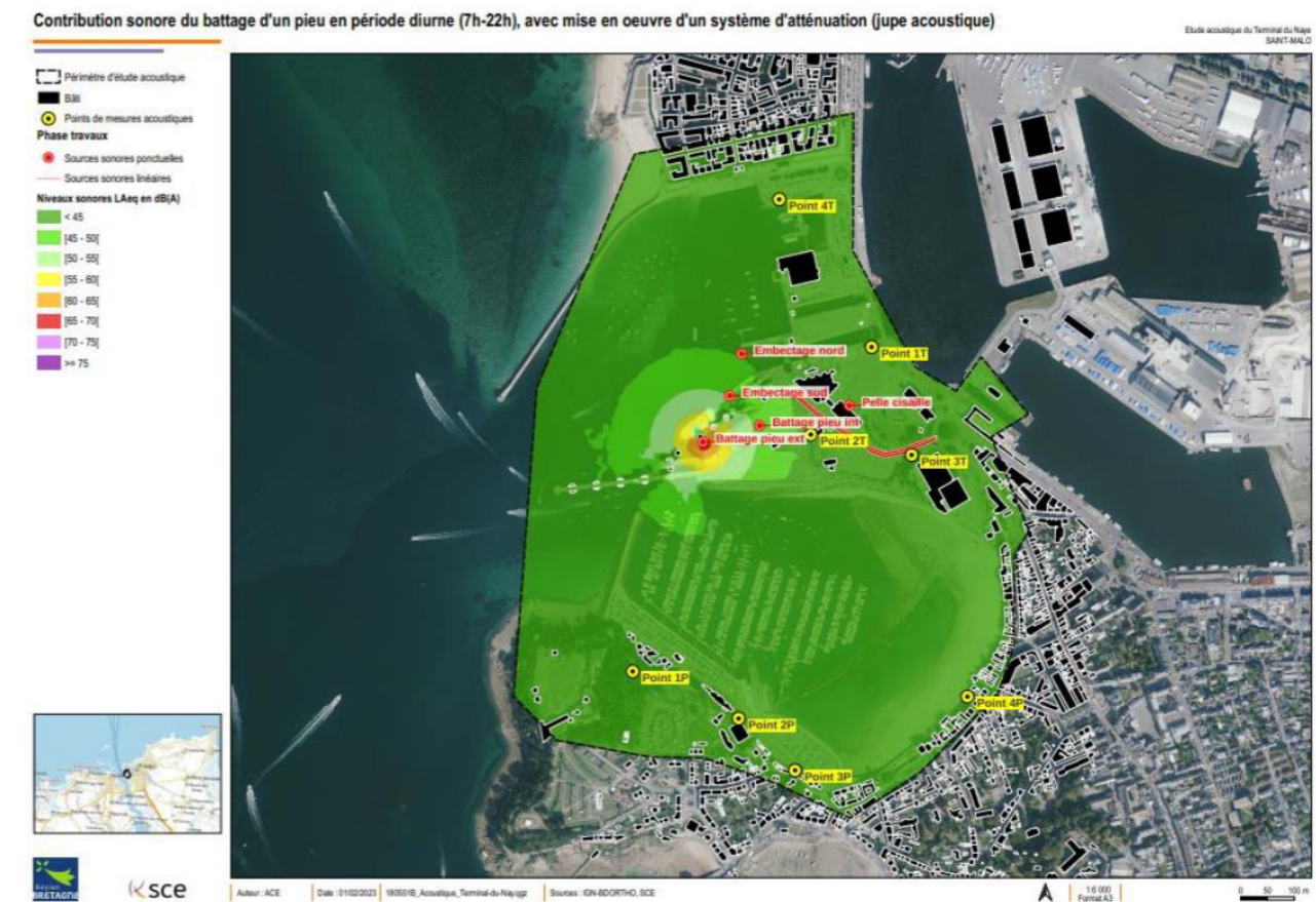
Figure 49 : Contribution sonore de battage d'un pieu en période diurne avec mise en œuvre d'un système d'atténuation (Source : Etude Acoustique Terrestre Phase 2, SCE, Février 2023)
