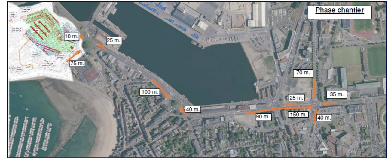
Figure 43 : Cartographie des longueurs maximales de congestion en phase travaux (Source : Modélisation trafic, phase 2, EMTIS, 2023)
