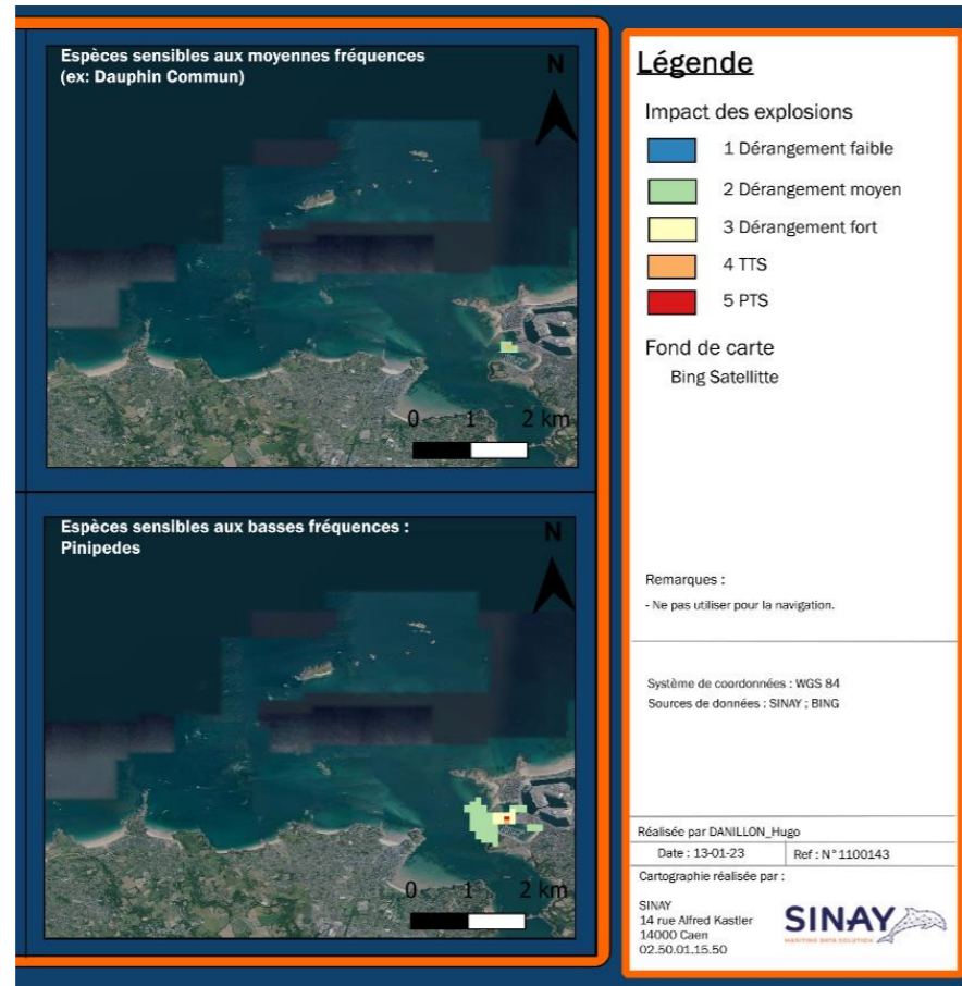
Figure 27: Impact en bruit continu du déroctage au BRH dans l'Avant-Port
